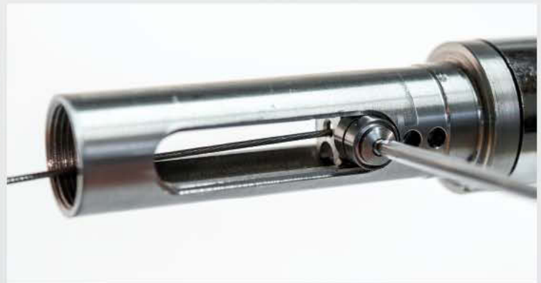
14 Sonderschraube mit Kugellagern und Distanzscheibe werden montiert
