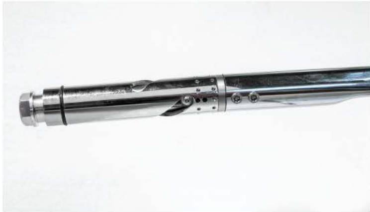
17 Die Lagerbundschaube verschleißt den Gasgriff
