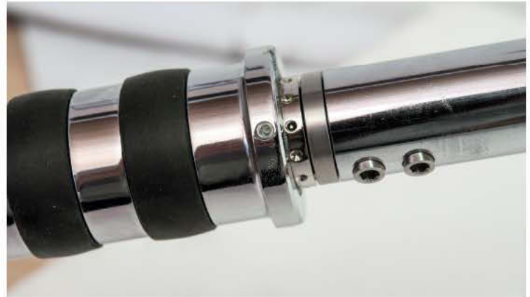
18 Die Klemmschrauben des Zubehör-Griffes werden an den vorgegebenen Bohrungen am Handgriff ausgerichtet
