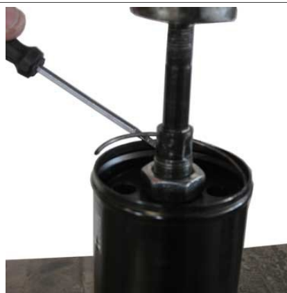
Bild 7, Sicherungsring entfernen bzw. montieren
