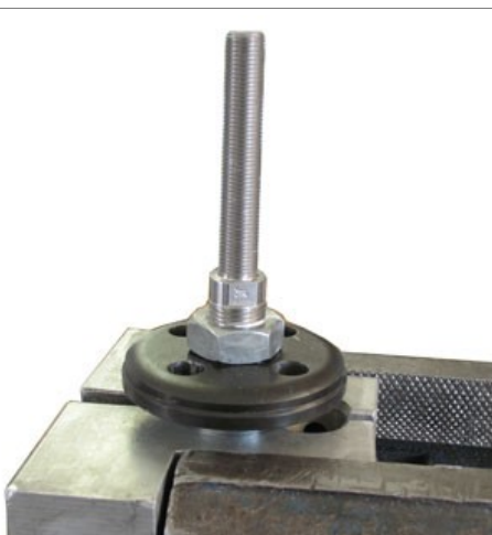
Bild 9 neue Gewindestange montiert.
