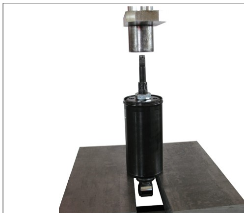
Bild 6, Federbein in Presse abstützen
