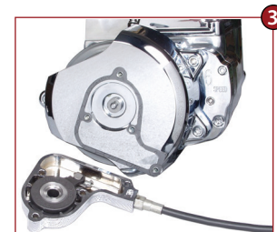
Deckel abmontieren, Segment tauschen Remove cover, change segment
