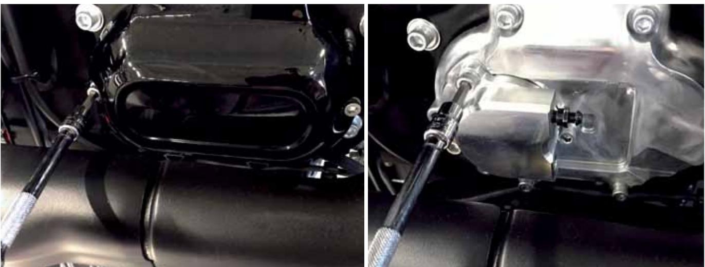
Der Deckel ist mit nur zwei Schrauben befestigt. Darunter sitzt der originale Ausrücker, der gegen den von Müller getauscht wird
