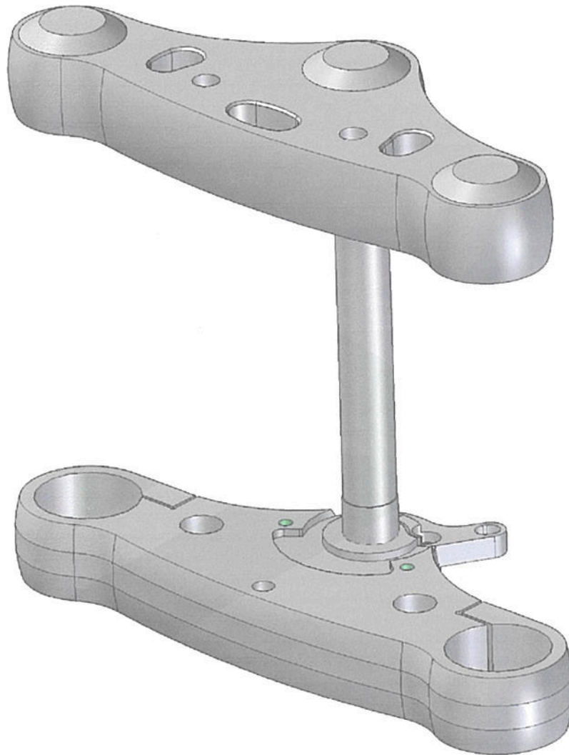
Bild:1 Gabelbrücke separat
