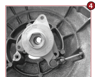
Kupplungs-Segment tauschen Change segment
