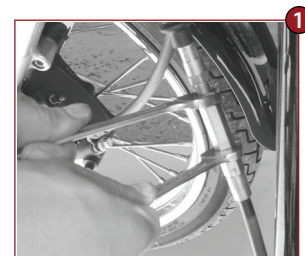
Kupplungszug lösen Relax clutch cable
